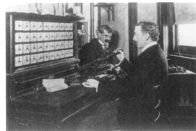
Figura 2.9 O tabulador eletromecânico de Hollerith.
